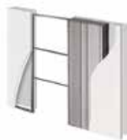
Parede de Gesso Cartonado Pared en cartón-yeso
